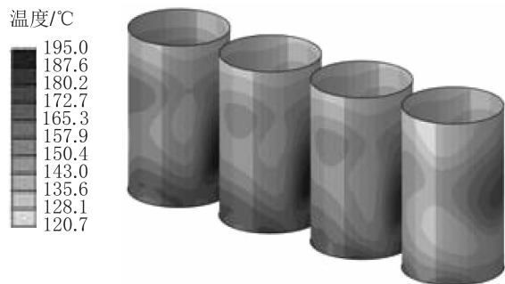
图12 缸体燃烧室壁面温度场分布图
